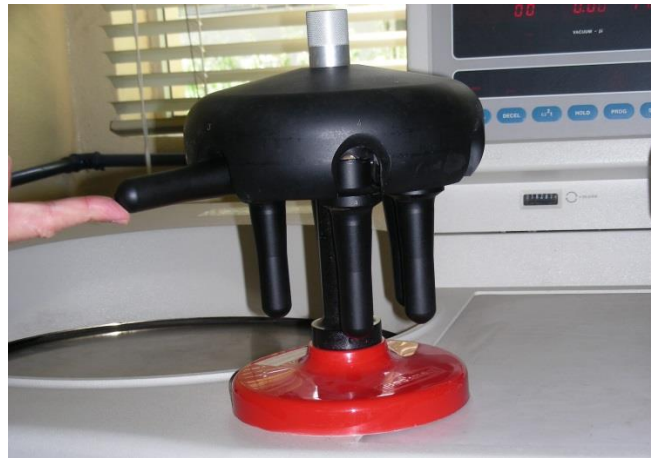
Figure 9. Swinging bucket rotor from Instituto Nacional de Investigação Agrária e Veterinária (INIAV).
